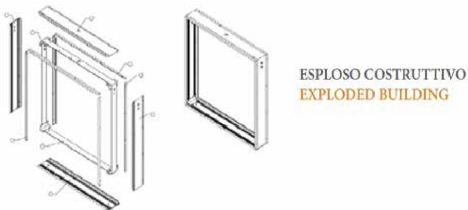
Esploso costruttivo del telaio porta pannello costituito da n.4 trafilati sagomati e da rinforzi interni ad angolo e longitudinali fissati tramite viti e saldatura a filo.
